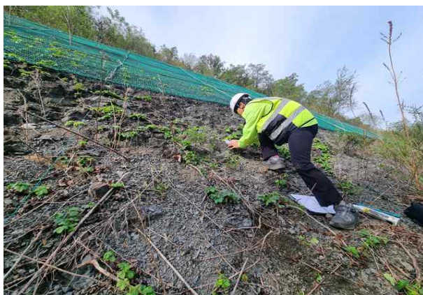
절리면 경사/경사방향 측정
